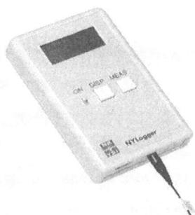
図3 皮膚温計測用温度データロガー
